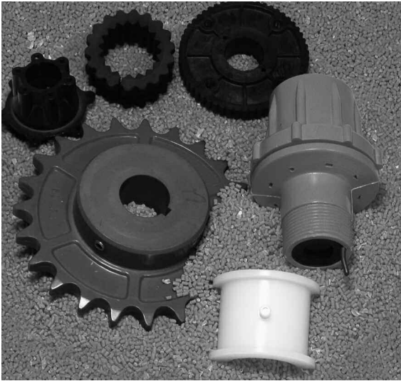
Los productos de plástico moldeados por inyección se pueden fabricar en una amplia variedad de tamaños y formas.
