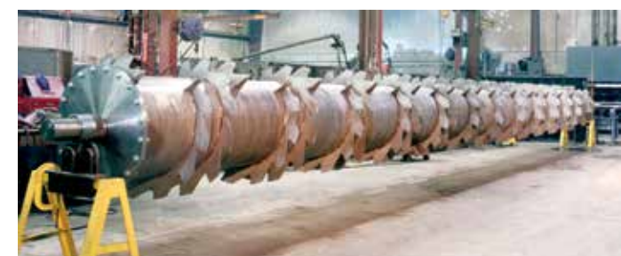
Helicoidais Duplex de aço inoxidável especial 2205, de 10 m de comprimento, 1 m de diâmetro, para transportar celulose.
