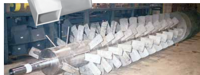
Transportador de Pás de 9 m de comprimento, 1,5 m de diâmetro, de aço inoxidável 316.
