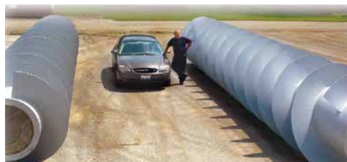
Helicoidais de duplo passo para bombeamento de água, de 14 m de comprimento, 2 m de diâmetro, feitos pela Martin .
